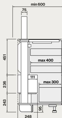
Vista laterale con motore in posizione anteriore
