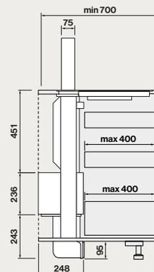
Vista laterale con motore in posizione posteriore
