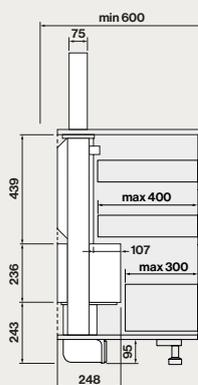
Vista laterale con motore in posizione anteriore
