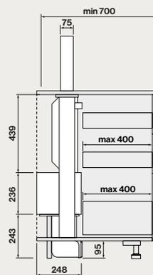
Vista laterale con motore in posizione posteriore
