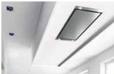
I vapori della cottura salgono verso la cappa con un'angolazione di 10°/15°. Per un funzionamento efficiente, è importante che l'intera struttura in cui viene installata la cappa a soffitto abbia una larghezza e una profondità almeno uguali a quelle del piano cottura. Inoltre, una veletta con altezza di 5-10 cm e una distanza di 30 cm dal bordo perimetrale della cappa riduce la quantità di vapori in uscita.
