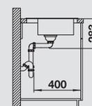
Per installazione su top di altezza inferiore ai 30 mm e fino a 15 mm di spessore, usare set ganci cod. 1223742 (v. pag. 262)
